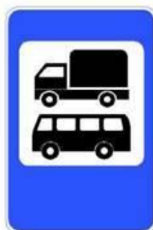
6.13 Пост транспортного контроля
